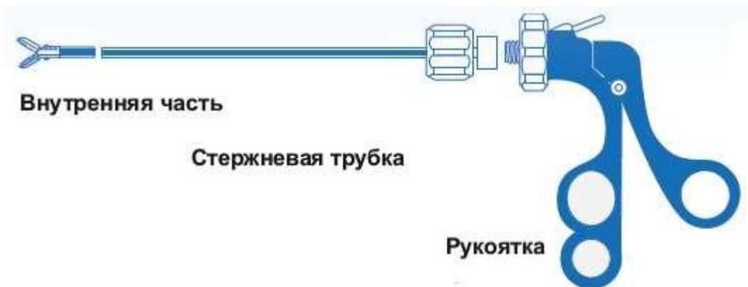
Рисунок 2.42 – Внешний вид и состав биопсийных щипцов диаметром от 5 до 10 мм, длиной от 220 до 450 мм
