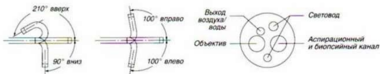
Рисунок 2.19 – Устройство конца и углы изгиба гастроинтестинального эндоскопа Olympus (Япония)
