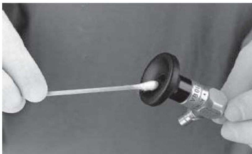
Рисунок 3.2 – Очистка оптических поверхностей
