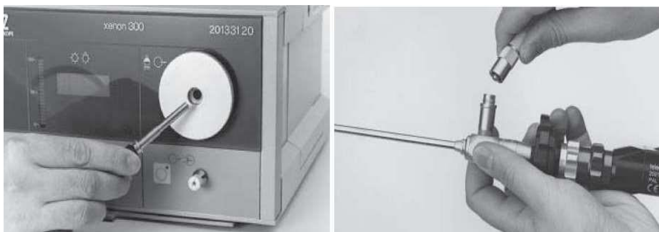
Рисунок 3.6 – Подключение камеры и эндоскопа KARL STORZ к источнику света с помощью светопровода
